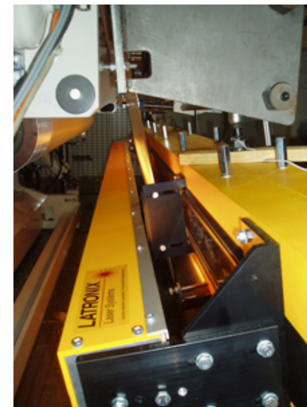
Breddmätning av flera pappersbanor med MWS
