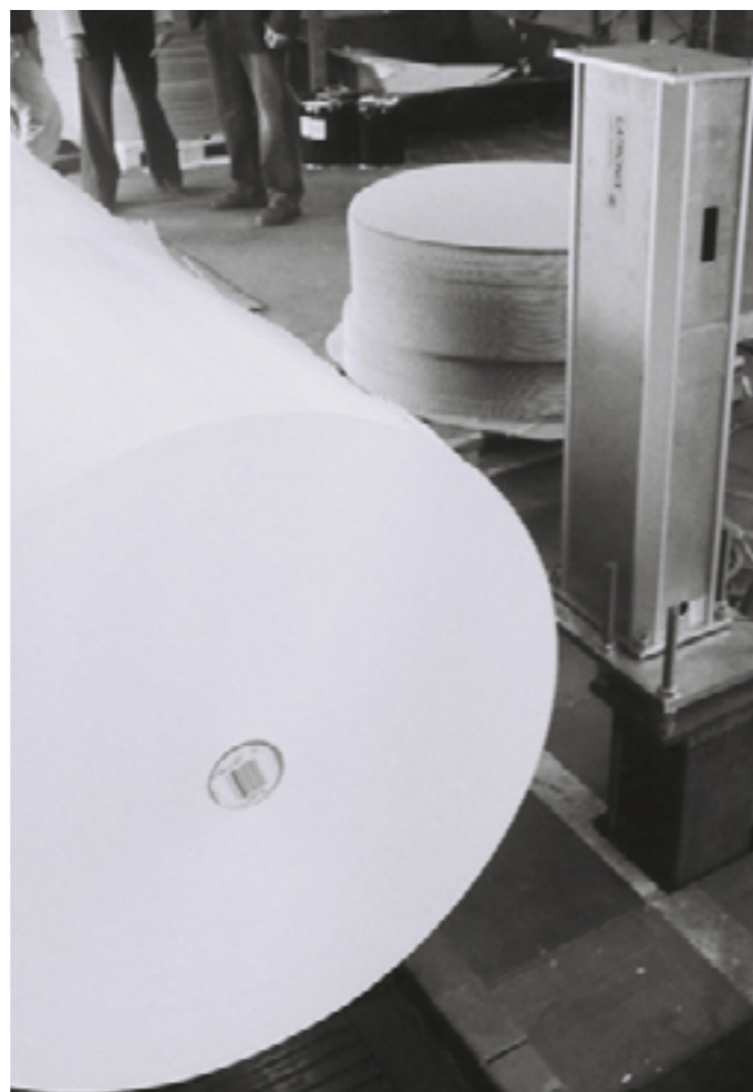
Euclides breddmätningssystem installerat på pappersbruk
