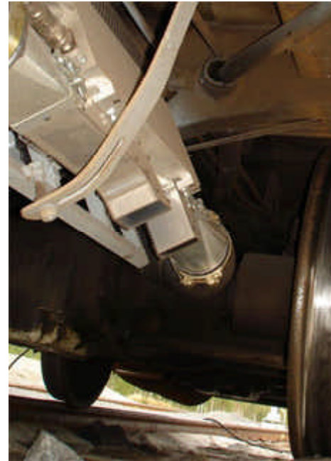
Rälkonturmätare monterad under arbetsfordon för mätning av den exakta positionen av rälsens överkant.
